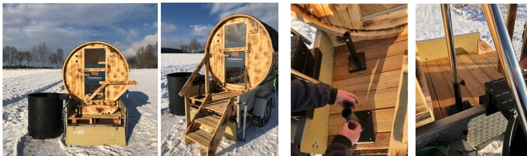
4. Den Spanngurt, welcher Tauchbecken und Treppe befestigt und die hintere Klappe des Anhängers lösen. → Den Spanngurt bitte vor Vereisung schützen
